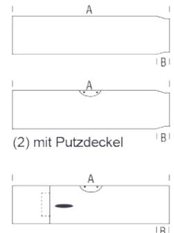
(3) mit Kondenswasserableitung, Putzdeckel, verstellbarer und arretierbarer Drosselklappe
